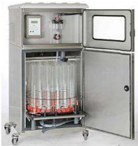
**Selbstentleerende Flaschen mittels Frischwasseranschluss**
