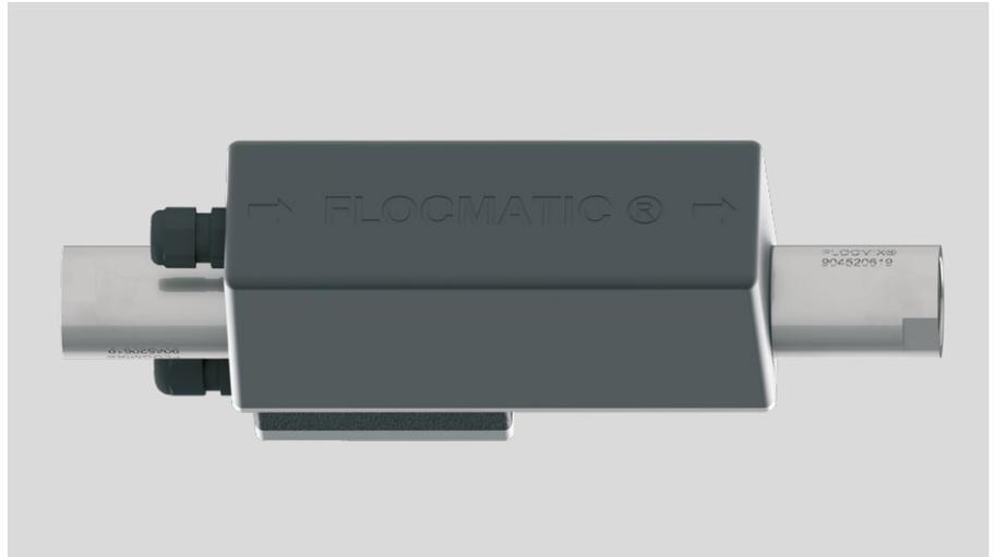
Mit der wartungsfreien **Flocmatic® Zentratwassersonde FMC2** ist es möglich, den permanenten Zentratwasserzustand zu überwachen. Hierdurch kann der intelligente Regler bei etwaigen Veränderungen unmittelbar eingreifen. Dabei werden geringere Mengen Flockungsmittel benötigt und es kann ein stabilerer Betrieb bei gleichzeitig geringerem Bedienungsaufwand der Zentrifugenanlage erreicht werden.
