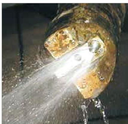
**Integrierte Sensor Reinigung**
