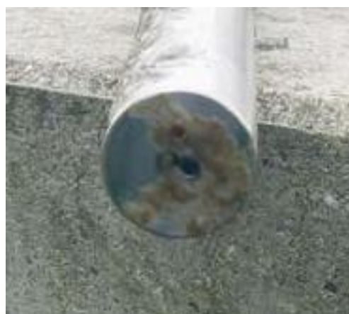
ViSolid® 700 IQ ohne Ultraschall-Reinhaltung ist nach 16 Tagen vollkommen mit einer biologischen Schicht überzogen.
