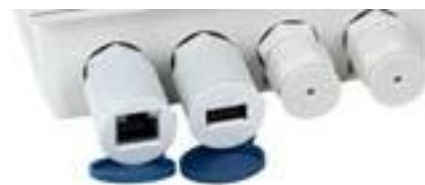
Anschlussleiste des Controller MIQ/MC3 mit Ethernet- und USB-Schnittstelle (links)
